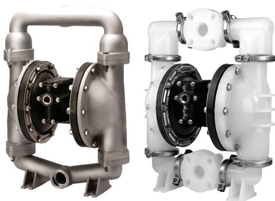
Pompa ideale per trasferire fluidi puliti. La scelta dei materiali del corpo pompa e delle membrane permette un'ampia compatibilità chimica con i fluidi trattati. La valvola aria in plastica assicura un funzionamento senza stallo alle basse pressioni e l'assenza di ghiacciamento dell'aria di scarico. Disponibile in materiali metallici (Alluminio ed Acciaio inox AISI 316) e plastici (PP, PVDF, PTFE da pieno).
